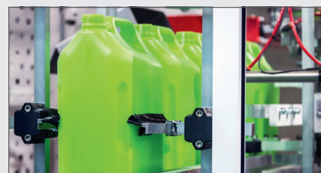
Inline-Farbüberwachung von Kunststoff-Flaschen
